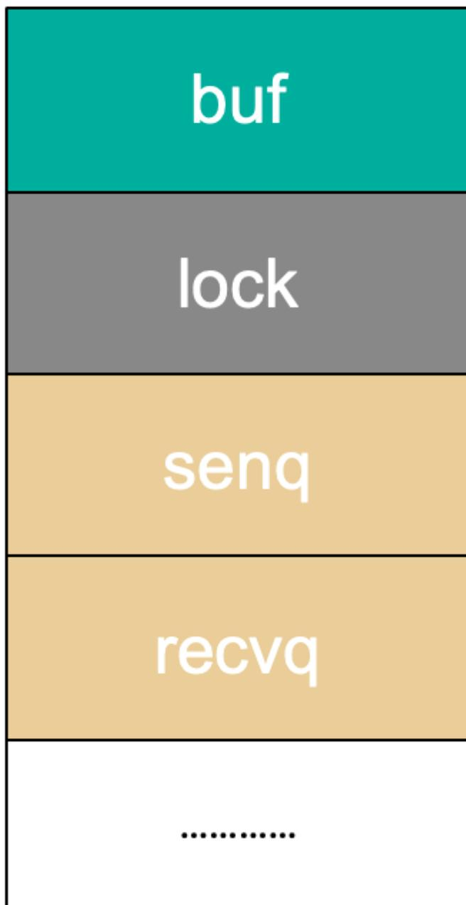
接着，第 15、16 行分别创建了一个 `goroutine`，各自执行了一个接收操作。通过前面的源码分析，我们知道，这两个 `goroutine`（后面称为 G1 和 G2 好了）都会被阻塞在接收操作。G1 和 G2 会挂在 channel 的 `recvq` 队列中，形成一个双向循环链表。
